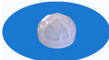
型号：7709-2 焦距：5 角度：89° 距离：5m 外径：17 内径：15
